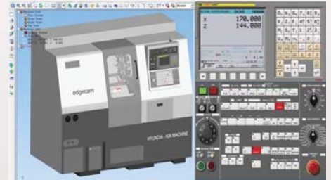
Simulación del Panel de Control (Modulo opcional)
